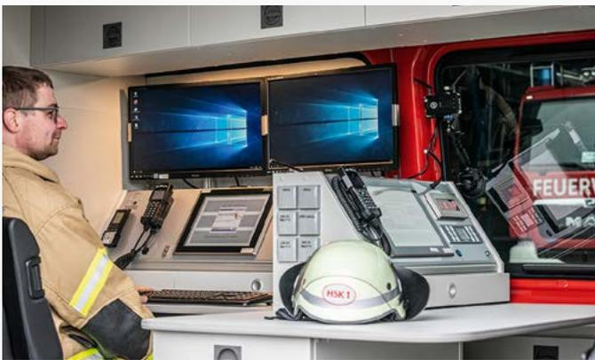
↳ Kommunikationsarbeitsplatz im Einsatzleitwagen ELW 1 mit Anbindung an die Digitalfunkstruktur im Gebäude
